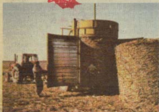
Emparvadora descargando el forraje. Se abren las puertas traseras, se retira el piso del depósito y el fardo queda depositado en el suelo.
