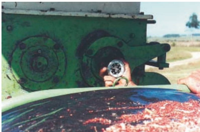
foto 6.- Midiendo revoluciones de los rodillos
