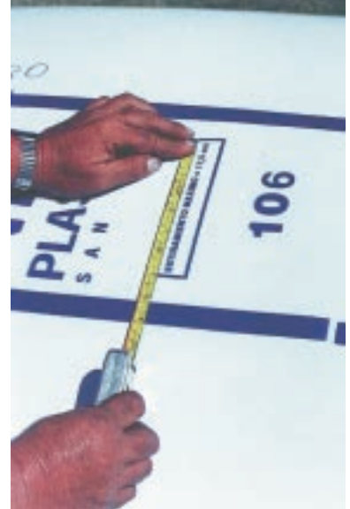
foto 3.- Midiendo el estiramiento de la bolsa.
