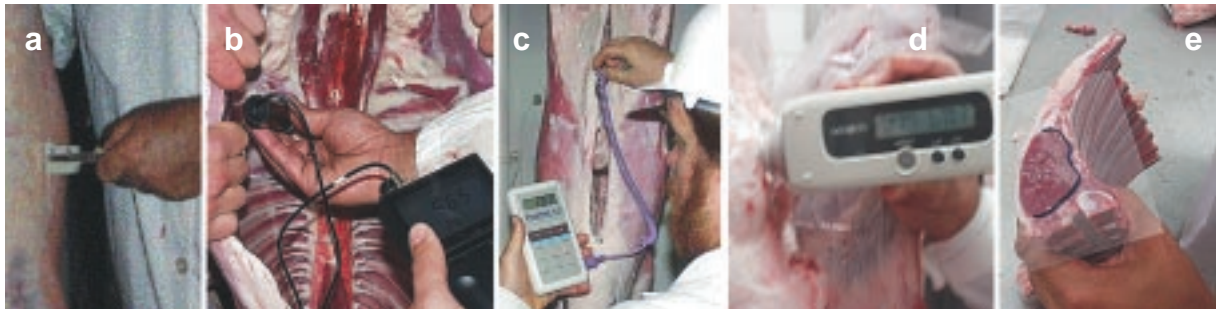
Foto 1: Mediciones del espesor del tejido subcutáneo - punto GR (a), pH (b), temperatura (c), color del músculo (d) y área del ojo de bife (e).
