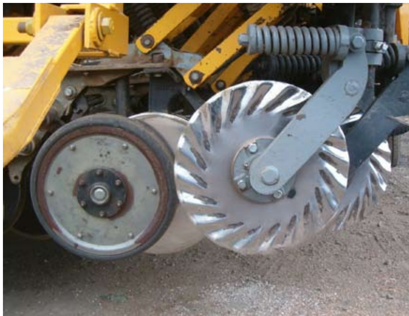
Foto 3. Cuchilla turbo de corte delantero. Ondulaciones tangenciales que facilitan la penetración y producen una microlabranza donde se deposita la semilla.
