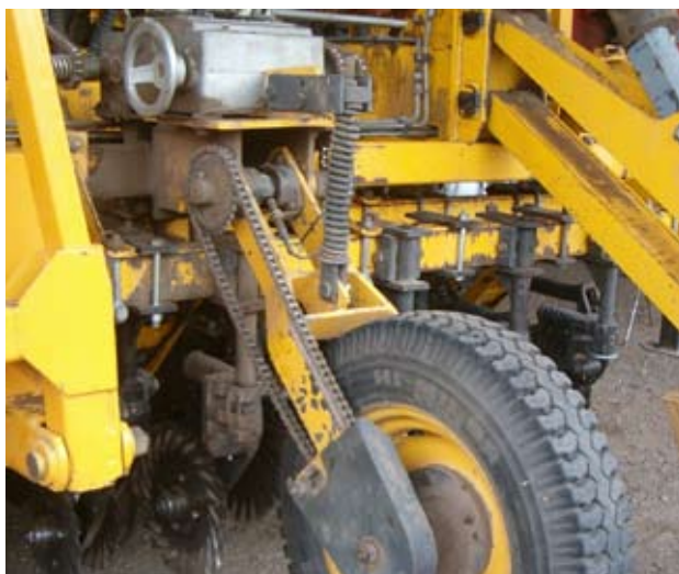
Foto 2. Rueda de transmisión independiente. Es posible regular la carga sobre la misma mejorando su adherencia al suelo, evitando arrastre e irregularidad en la entrega de semillas.
