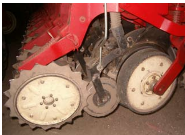
Foto 4. Abresurcos de disco oblicuo (monodisco). Rueda contactadora de semillas y tapador de discos dentados.
