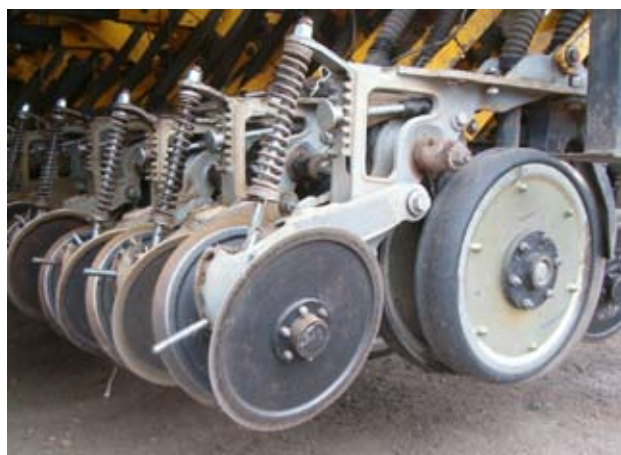
Foto 5. Abresurcos de discos dobles. Rueda limitadora de profundidad adosada a los discos y tapadores de ruedas angulares
