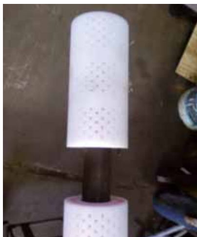
Distribución de agujeros en la barra de nylon de 110 mm. Nótese la fijación de la misma al eje.
