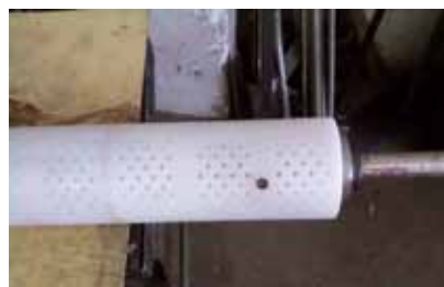
Estructura modular de la barra de nylon y su encastramiento con las restantes.
