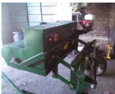
Sistema de tiraje con dos posiciones, trabajo y transporte.
