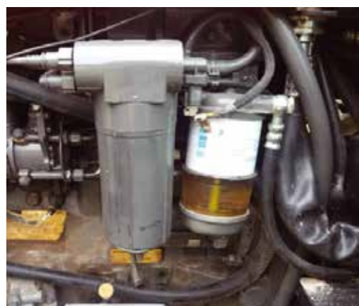
Vista de filtro de gasoil primario con la trampa de agua debajo y filtro de gasoil secundario a la izquierda.
