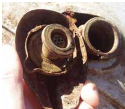
Foto: Tapa de radiador en mal estado.
