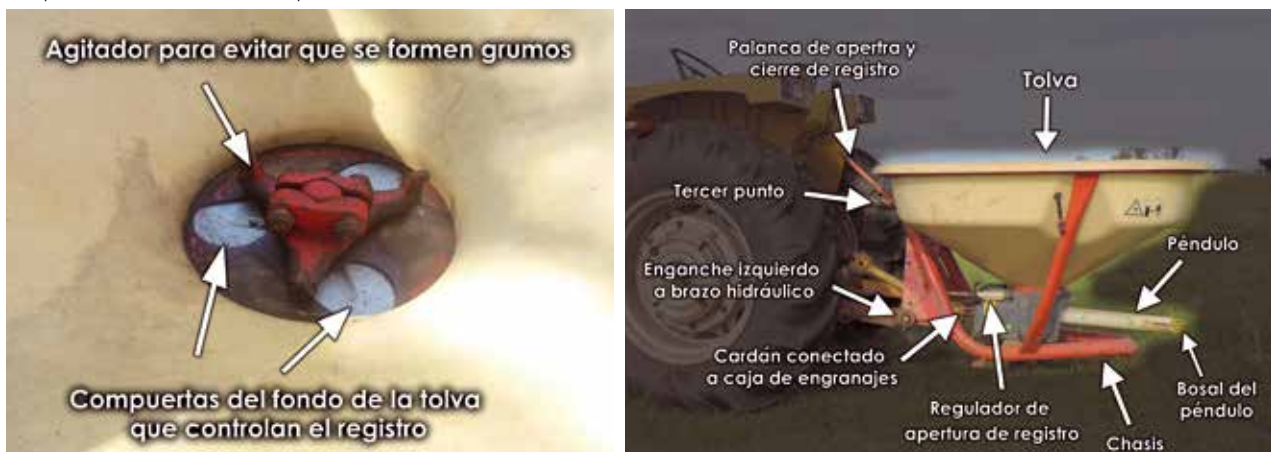
Componentes de una fertilizadora pendular
