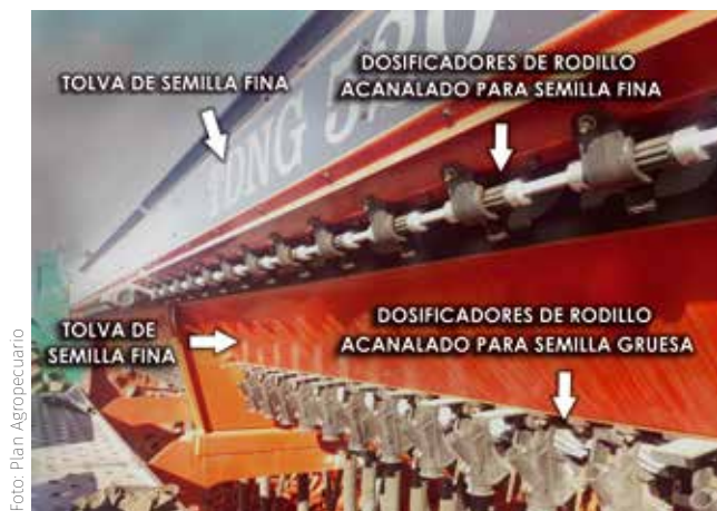
Figura 1. Vista posterior de una sembradora a chorrillo con sus tolvas de semilla fina (arriba), de semilla gruesa (abajo) y los respectivos dosificadores de rodillo acanalado (arriba y abajo).
