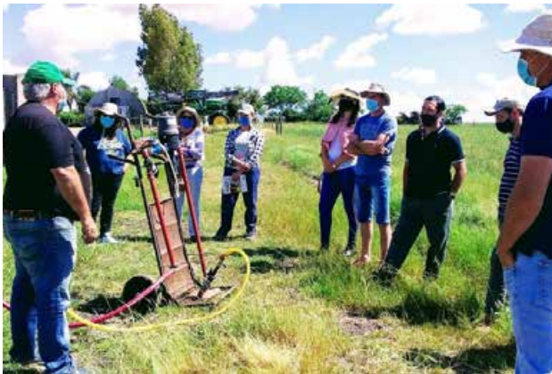
Foto 2. Recorrida en establecimiento “El Retoño” de la Flía. Tornielli-Espinel. En la imagen el productor describe un sistema diseñado en el propio predio para control de meteorismo con el agua de bebida a animales pastoreando alfalfa.
