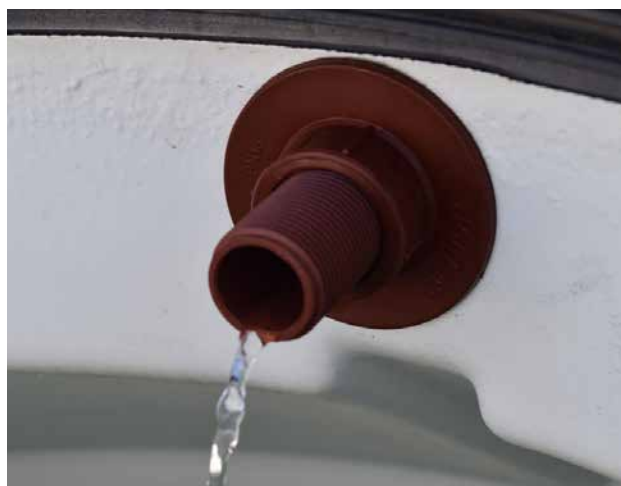
Foto 5. Aforo del caudal en la descarga del tanque de reserva en período de sequía.
